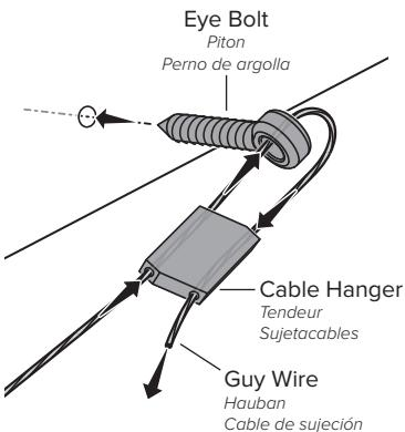
Fixez les pitons à la structure d'ancrage de sorte que les haubans forment un angle d'environ 45° avec la tige de prolongation, vus latéralement, ainsi qu'un angle d'environ 90° entre eux, vus du dessus. Faites passer chaque hauban dans un tendeur, dans le piton, puis à nouveau dans le tendeur. Tendez uniformément les quatre haubans au moyen de tendeurs. Ne serrez pas les tendeurs tant que tous les haubans ne sont pas en place.
